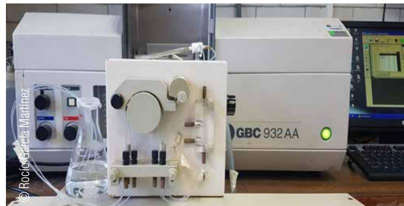
Figura 2. La espectrometría de absorción atómica es una buena alternativa para cuantificar metales tóxicos.
